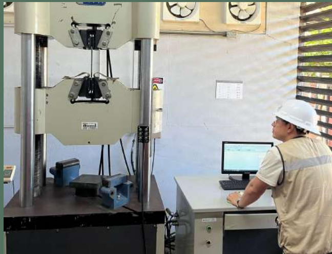
ENSAYO DE TENSIÓN EN VARILLAS DE ACERO ASTM A615. ASTM A706
